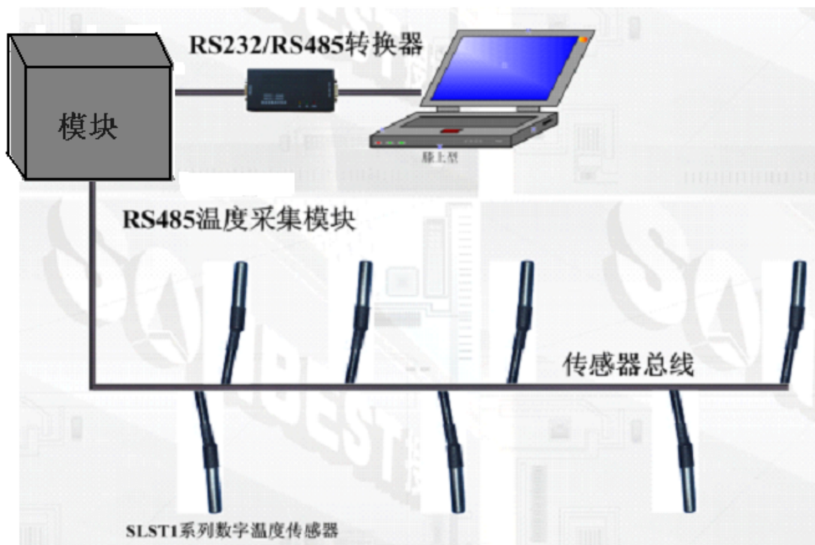
图 1.1 测温原理示意图
