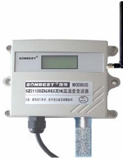
SZ2110-2 温湿度配合美国瑞士专用温湿度传感器及 ZIGBEE 无线技术, 基于工业用 MODBUS-RTU 协议, 实现低成本温湿度状态在线监测的实用型一体化传感器。
